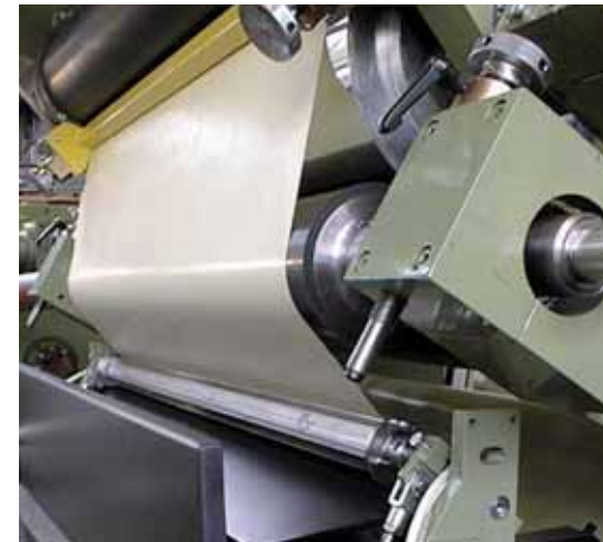
Doppelschaber für beidseitige Dosierung nach der Tauchbeschichtung
