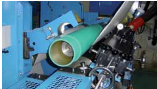
Sleevewechsel in der Maschine ohne Bahntrennung
